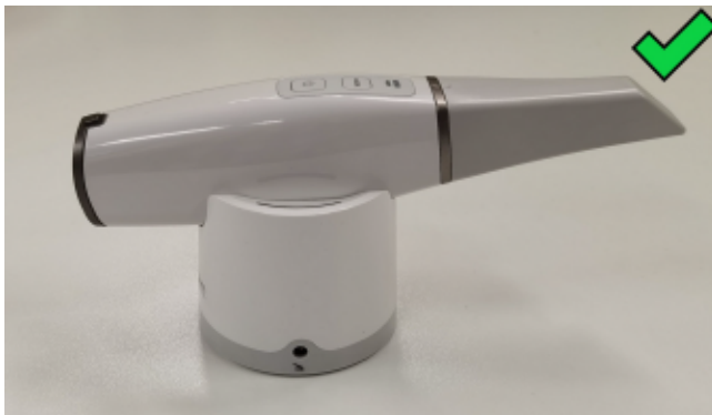
그림 5 IS 3800W 를 충전 스테이션에 수평으로 보관(팁이 위로 향하게)
